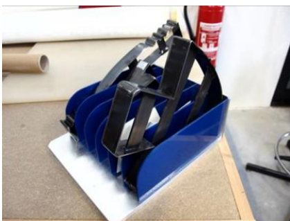
Figura 20: Depozitarea corectă a cuțitelor de croit
