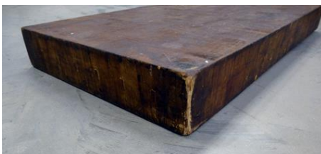
Abbildung 25: Stanzunterlage aus Hirnholz
