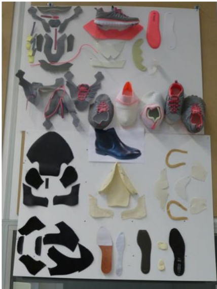
Abbildung 1: Darstellung der Komplexität des Schuhaufbaus
