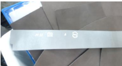
Abbildung 36: Stempeln der Teile
