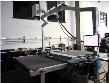
Abbildung 26: Stanzmesserloser Schneidetisch mit oszillierendem Messer
