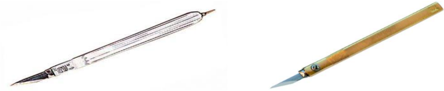
Abbildung 16: Zuschneidmesser für den Handzuschnitt
