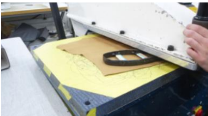
Abbildung 37: Zuschnitt auf einer Schwenkarmstanze
