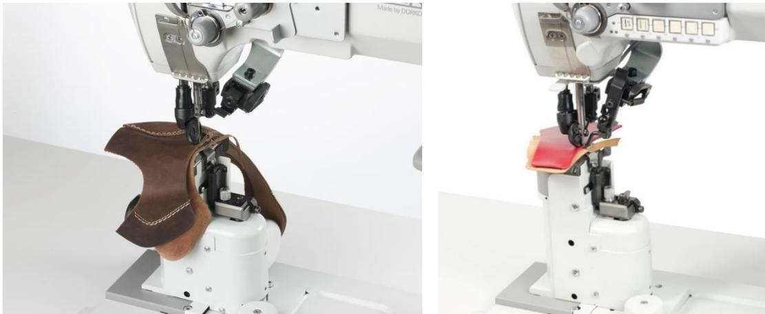
Fig. 3: Máquina de columna con transmisión directa integrada para insertar el forro y desvirar cantos
