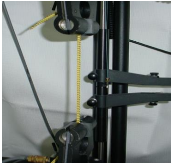
Fig. 44: Resistência à tração de atacadores
