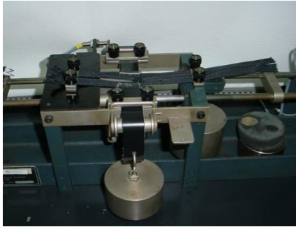
Fig. 41: Resistência ao uso. Força de fixação do puxador. Força de fixação do stop inferior. Força de fixação do stop superior. Resistência à tração lateral
