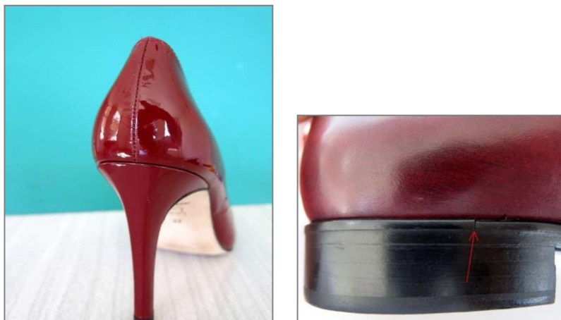
Fig. 21: Vira adequadamente unida ao solado. Assento do calcanhar firmemente preso e salto alinhado
