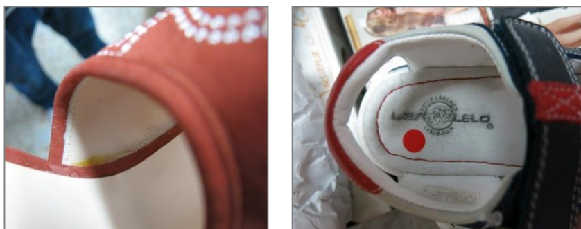
Fig. 25: Presença de manchas, pregas no forro, marcação correta na palmilha de acabamento
