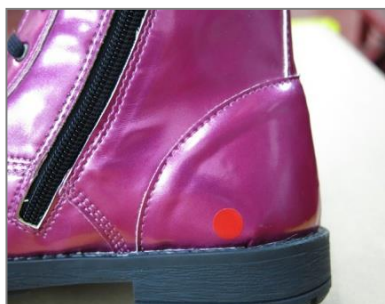
Fig. 18: Pregas causadas por deficiências nas operações de montagem
