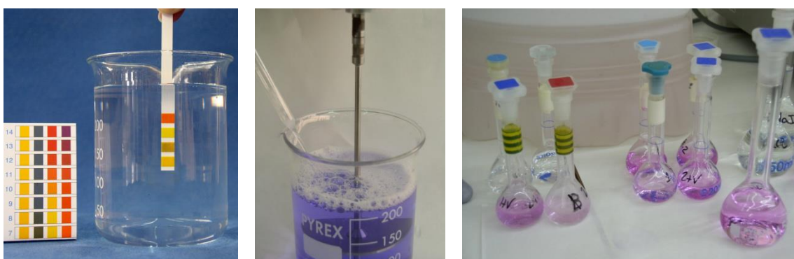
Fig. 53: Testes químicos em laboratório para deteção de substâncias proibidas ou restringidas (cromo VI, matéria volátil, sulfatos, carbonatos, etc.)
