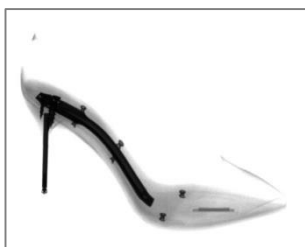
Fig. 26: Presença de pregos ou agrafos, comprimento e posição do enfuste
