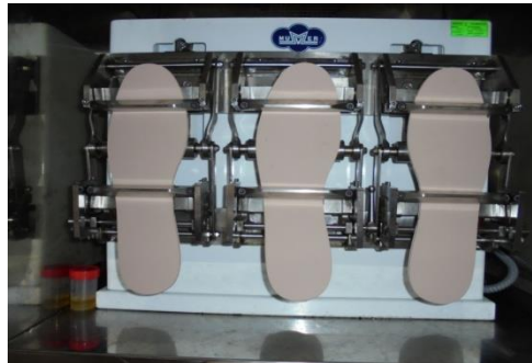
Fig. 47: Resistencia a la flexión
