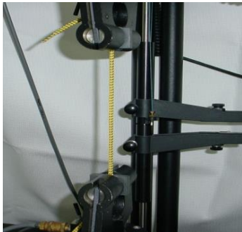
Fig. 44: Resistencia a la tracción de los cordones
