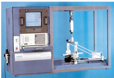
Fig. 48: Resistencia al deslizamiento
