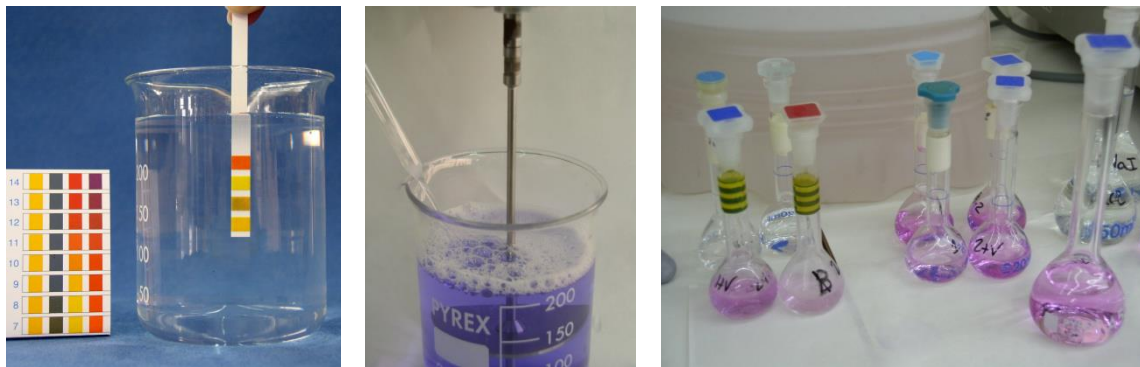
Fig. 53: Ensayos químicos en laboratorio para la detección de sustancias restringidas o prohibidas (cromo VI, materias volátiles, sulfatos, carbonatos, etc.)
