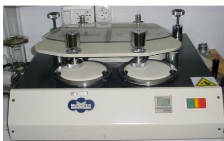
Fig. 39: Resistencia a la abrasión
