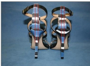
Fig. 10: Rectitud de la costura trasera o centrado de la trasera
