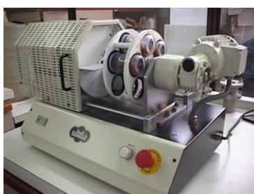
Fig. 38: Permeabilidad al vapor de agua
