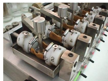
Fig. 37: Penetración y absorción de agua
