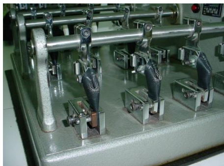
Fig. 29: Resistencia a la flexión
