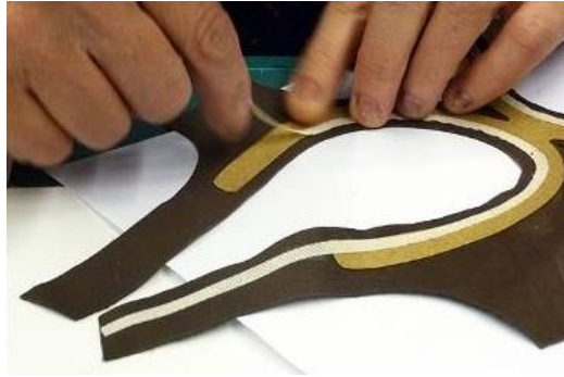
Fig. 10: Colocar fita de reforço
