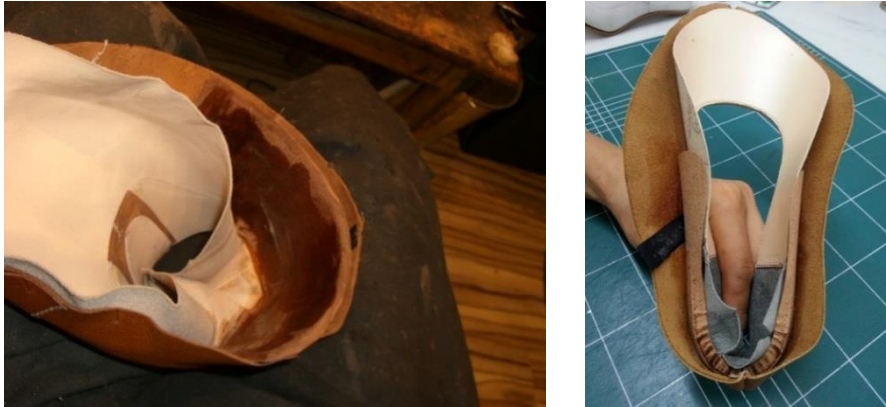
Fig. 3: Aplicação do contraforte; Fonte: http://denishoe.blogspot.com/2013/07/lasting-7-wrapping-last-with-upper.html
