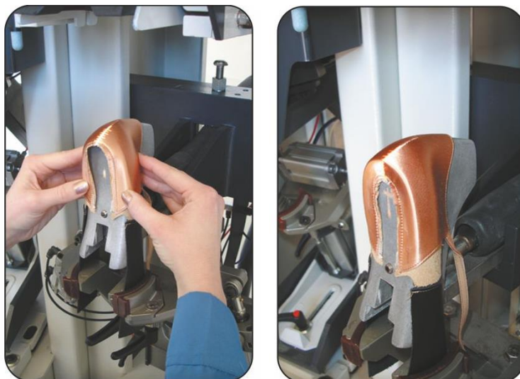
Fig. 4: Pré-moldar o contraforte; Fonte: www.olympicltd.gr/en/multiform4
