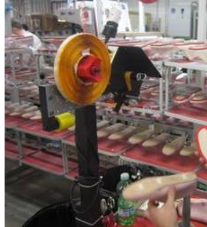
Fig. 9: Fixar a palmilha à forma com fita; Fonte: www.tapepeel.com/en/tapepeel/
