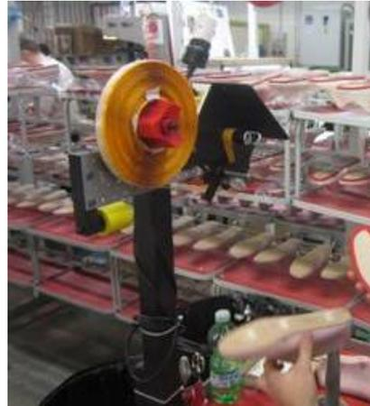
*Fig. 9: Aplicación de la palmilla a la horma empleando cinta;*
