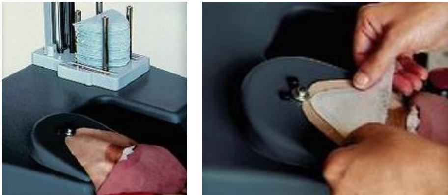
Fig. 2: Applying the toe puff; Source: www.olympicltd.gr/gr/tpa-11-2
