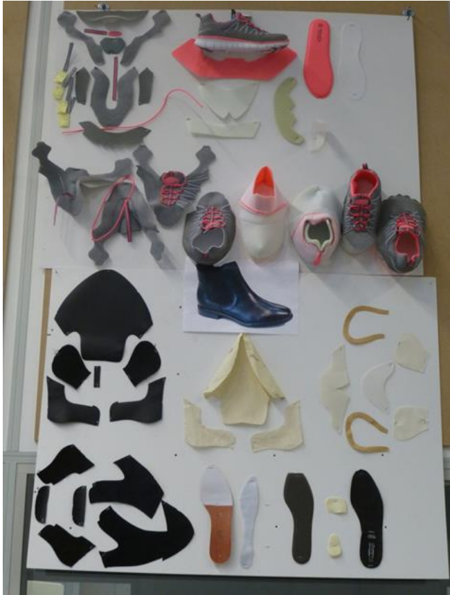
Fig. 1: A apresentação das peças do sapato, como nesta foto, pode ser muito útil para o formando entender a complexidade de um sapato.
