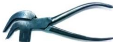
Fig. 43: Turquês de montagem: ferramenta para acertar a altura da taloeira do sapato
