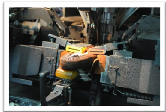
Fig. 52: Posto de Trabalho e de aprendizagem (WBL)/Fechar enfranques e calcanheira - Carité
