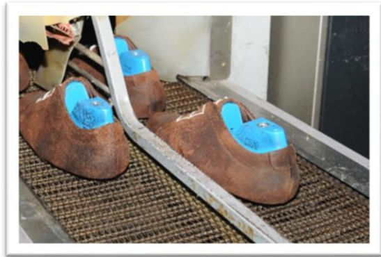
Fig. 51: Posto de Trabalho e de aprendizagem (WBL)/ Máquina de humificação e calor - Carité
