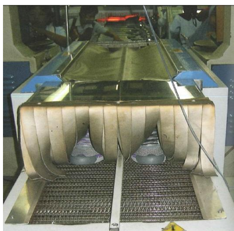
Fig. 46: Túnel transportador, de humidificação e calor
