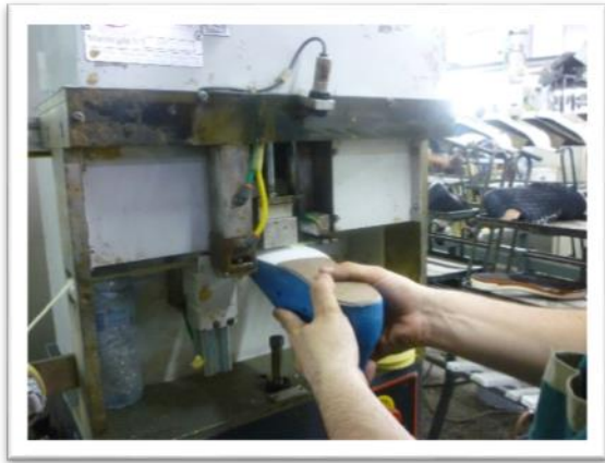
Fig. 48: Posto de Trabalho e de aprendizagem (WBL) / Aplicação da palmilha de montagem na forma - Carité
