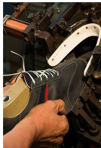
Fig. 40: Centrar o sapato em relação às pinças e ao teflon
