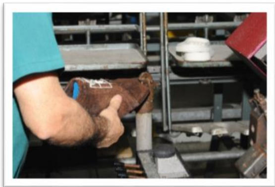
Fig. 49: Posto de Trabalho e de aprendizagem (WBL)/ Posicionar o corte/gáspea na forma - Carité
