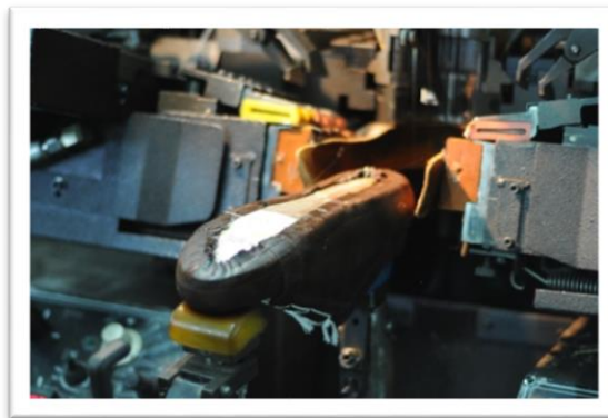
Fig. 52: Posto de Trabalho e de aprendizagem (WBL)/Fechar enfranques e calcanheira - Carité
