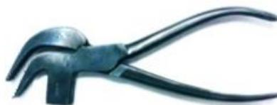
*Fig. 43: Alicates de montaje: herramienta para ajustar la altura del zapato*
