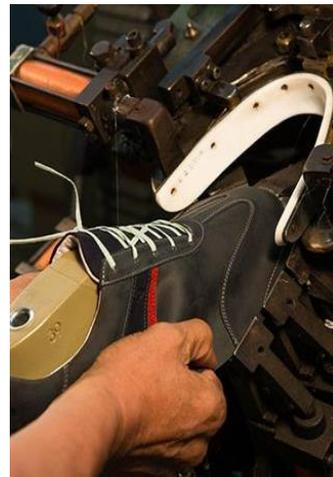
*Fig. 40: Centrado del zapato en relación con las mordazas y el teflón*
