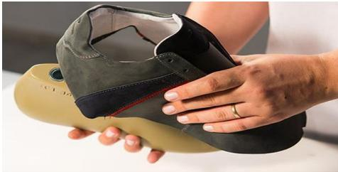
*Fig. 39: Colocación del corte sobre la horma*
