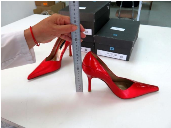
Figura 2: Riglă pentru a măsura înălțimile și distanțele
