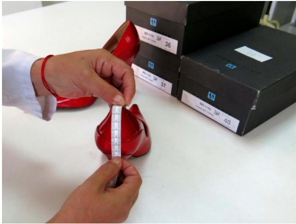
Figura 3: Centimetru necesar pentru măsurarea curbelor
