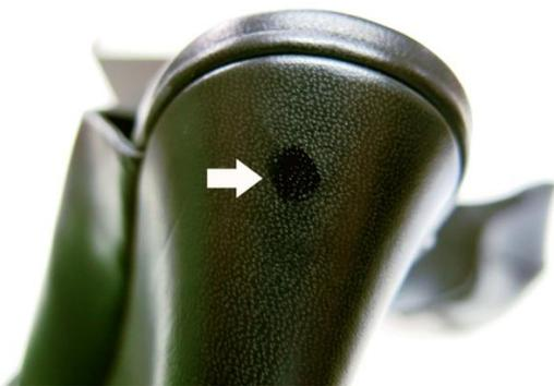
Fig. 8: Autocolante branco com formato de seta para assinalar os defeitos
