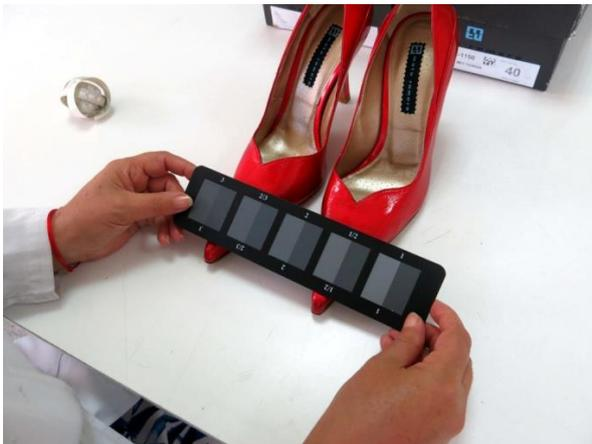
Fig. 4: Escala de cinzentos para avaliar variações de cor entre a amostra de confirmação e as amostras produzidas
