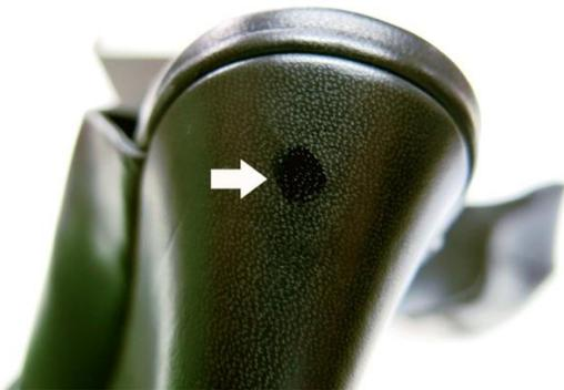
Abb. 8: Klebeetikett in Pfeilform, um gefundene Fehler zu markieren
