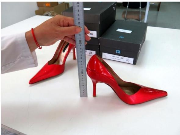
Abb. 2: Lineal, beispielsweise zur Höhenmessung
