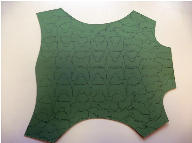
Abb. 4: „Lederhaut“ aus Karton (Maße: 40x50 cm), auf der die Auszubildenden das Auslegen mit den Miniaturschablonen üben können
