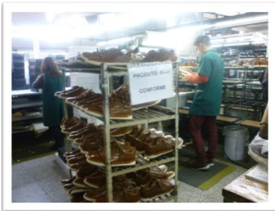
Estrutura para colocar o produto não conforme
