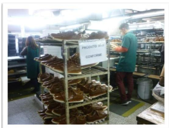
Estructura para colocar los productos no conformes
