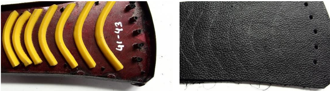
Fig. 21: Os cortantes podem ser equipados com punções, marcadores ou outros, eliminando subseqüentes operações
