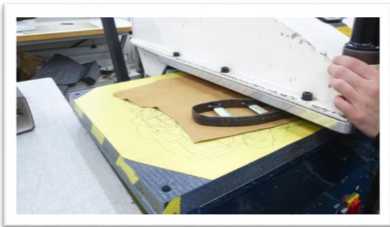
Fig. 37: As palmilhas de acabamento, em pele, são cortadas com cortantes num balancé de braço.
