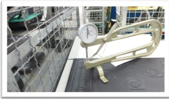
Fig. 35: Medidor de espessura para controlar a espessura final.
