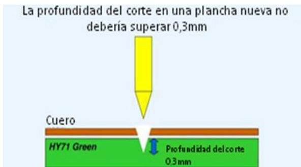
Fig. 11: Cómo ajustar una troqueladora hidráulica adecuadamente. (Imagen: Hydroma)
