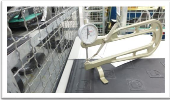
Fig. 24: Medidor de grosor para controlar el resultado del dividido.
