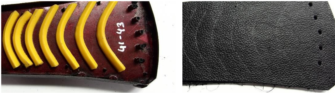
Fig. 10: Los troqueles pueden incluir boquillas de picados, calados o marcas, que evitan realizar operaciones posteriores.
