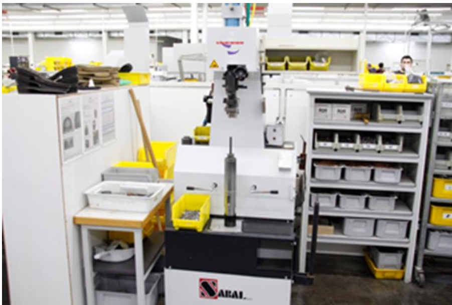
Fig. 20: Máquina de aparafusar saltos. Crédito: Gabor
