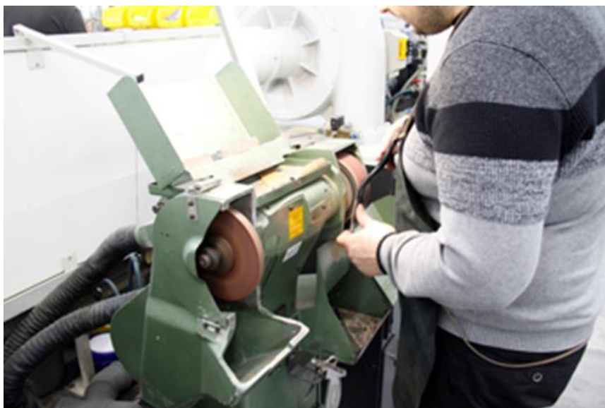
Fig. 16: Preparação da palmilha de montagem com forra. Crédito: Gabor
