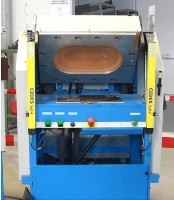
Fig. 19: Prensa pneumática com dupla membrana. Crédito: ISC
