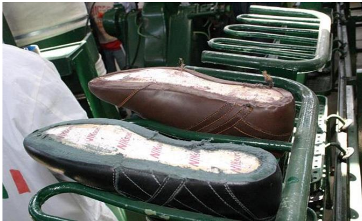
Fig. 7: Se existir pó na superfície lixada, este deverá ser retirado pois acabará por enfraquecer a adesão e coesão da colagem. Fonte: ISC
