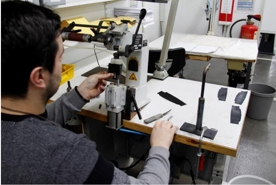
Fig 13: Dispositivo de fixação utilizado para revestimento dos saltos com couro. Crédito: Gabor
