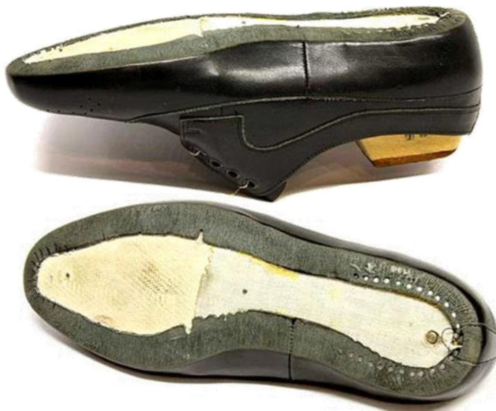
Fig. 5: Resultado de uma lixagem perfeita. A resistência da estrutura do corte de couro é mantida e a área de contacto para o filme de cola foi aumentada. Fonte: ISC
