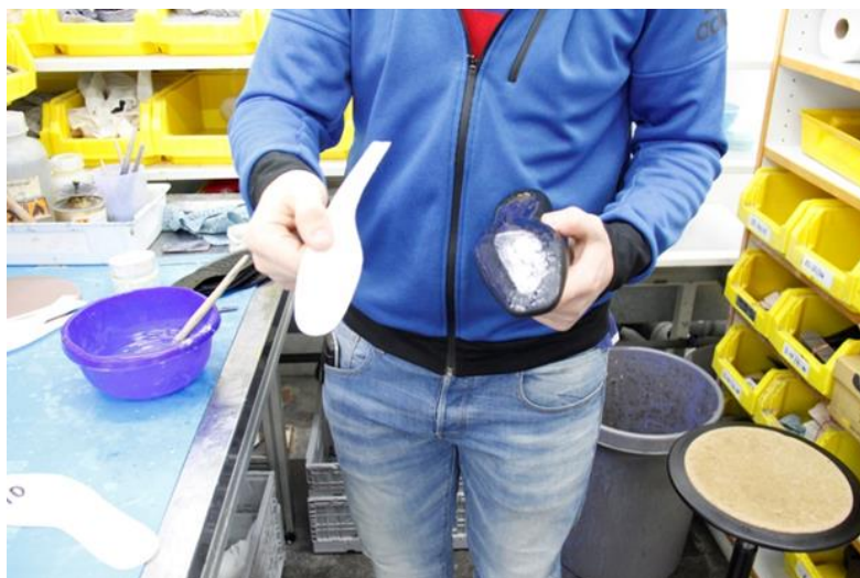
Fig. 10: A função do enchimento é anular a diferença da altura entre o bordo de montagem e a palmilha de montagem. Crédito: Gabor
