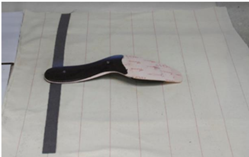
Fig. 15: Palmilha de montagem e tira de couro para ser colada a toda a volta. Crédito: Gabor
