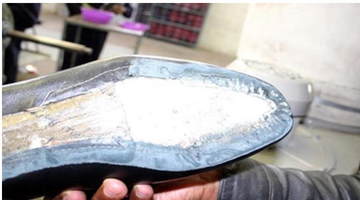
Fig. 6: Exemplo de um corte demasiado lixado: a testeira é visível. A resistência da junção da sola estará agora completamente dependente da resistência da estrutura do forro e da testeira. Fonte: ISC
