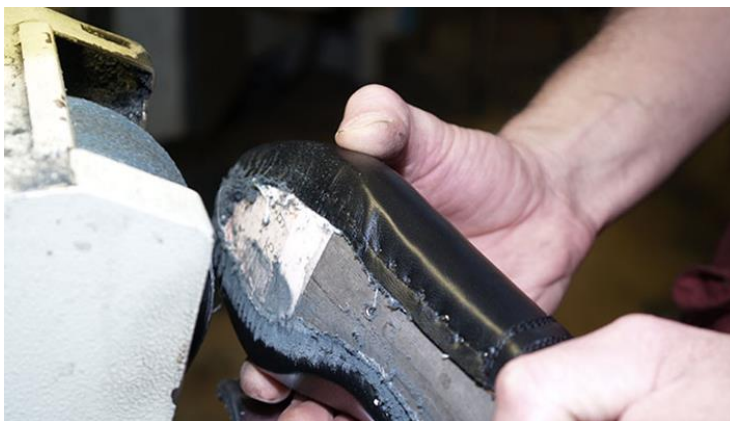
Fig. 3: Lixagem (lixa áspera). Fonte: ISC
