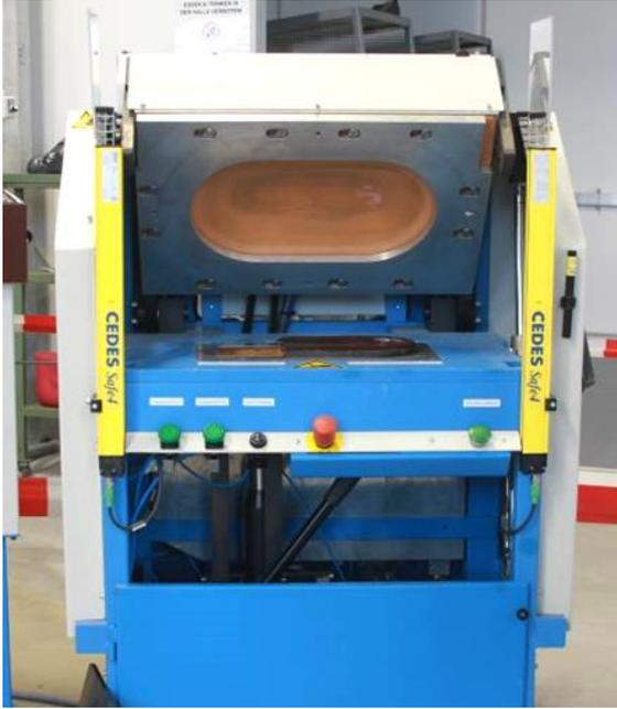
Fig. 19: Prensa neumática de doble membrana. Fuente: ISC
