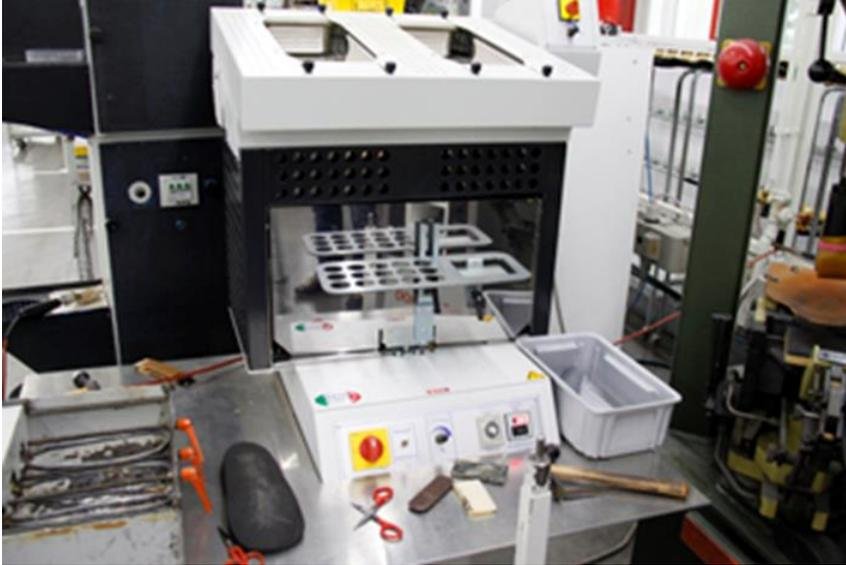
*Fig. 17: Dispositivo de activación para suelas*
