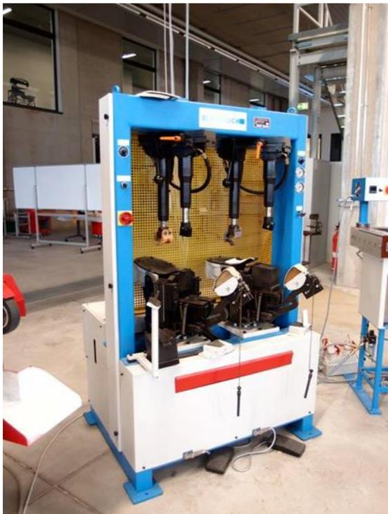
*Fig. 18: Prensa hidráulica para suelas. Fuente: ISC*
