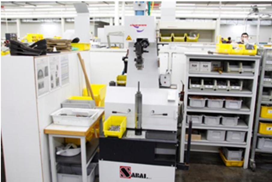
Fig. 20: Máquina para atornillar los tacones. Fuente: Gabor
