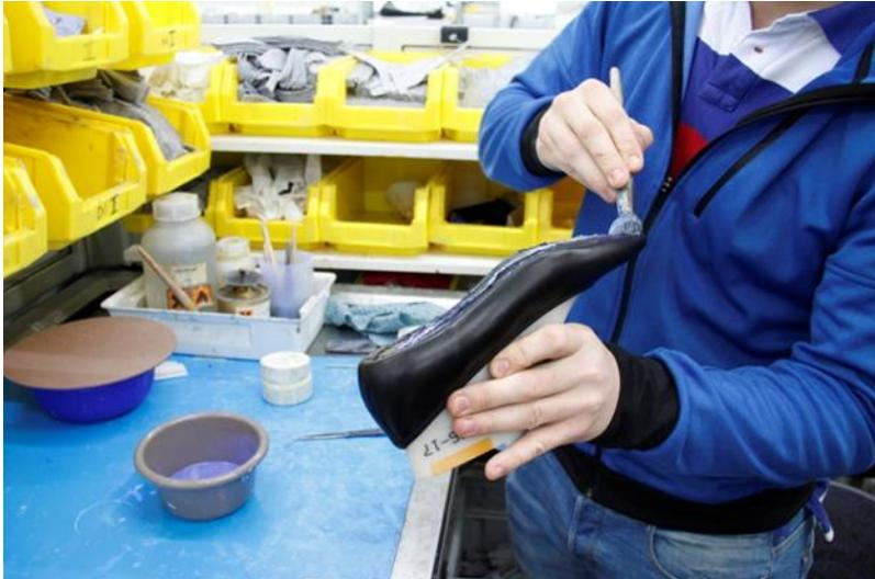
*Fig. 9: Aplicación de la imprimación. Fuente: Gabor*
