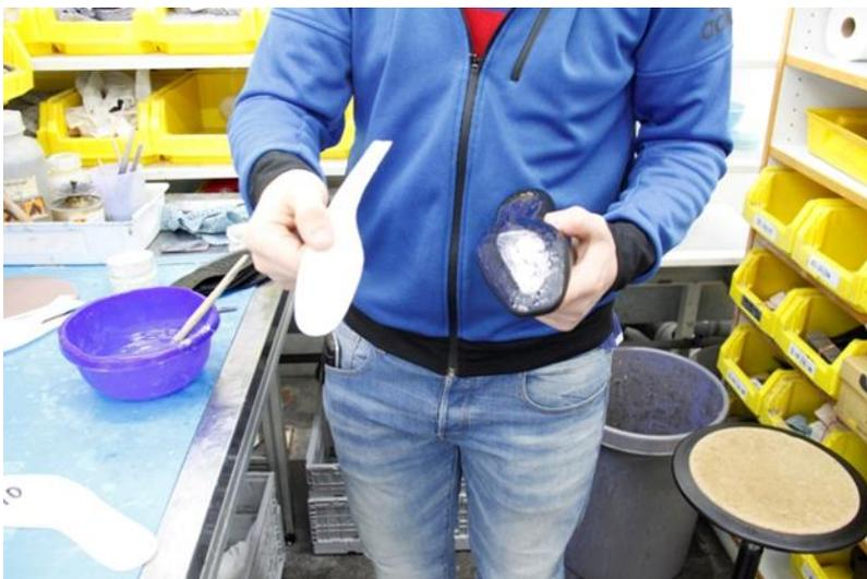
*Fig. 10: La función del relleno de planta es nivelar la diferencia en altura entre el borde de montaje y la palmilla. Fuente: Gabor*
