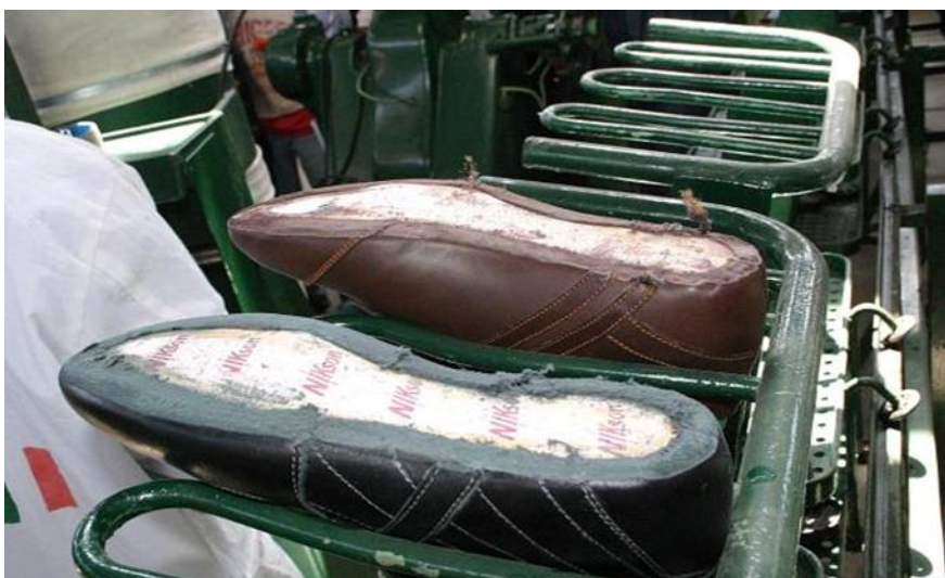
Fig. 7: Si el polvo de cardado permanece en la superficie de cardado, se cubrirá con adhesivo en el siguiente paso, lo que también debilita la unión. Fuente: ISC
