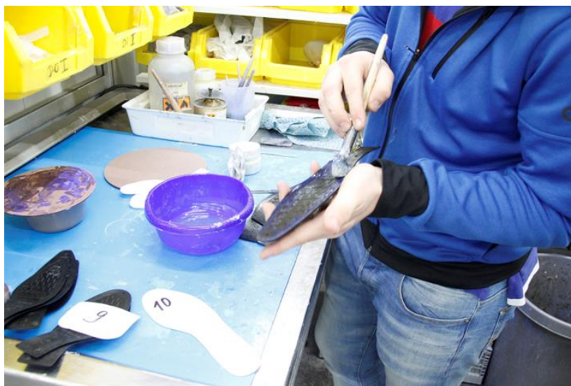
Fig. 11: Aplicación de la cola a la suela. Fuente: Gabor
