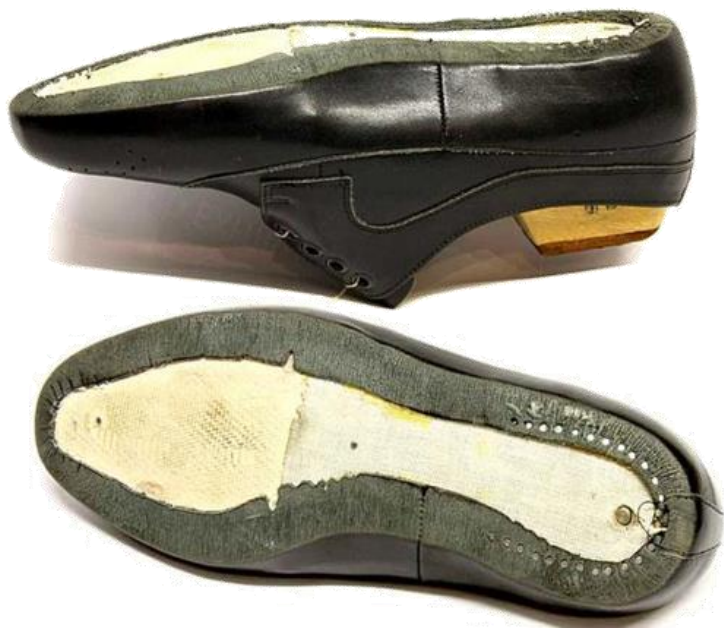
Fig. 5: Resultado de un cardado perfecto. La resistencia estructural del cuero se mantiene y el área de contacto de la unión adhesiva se ha incrementado. Fuente: ISC
