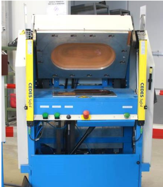
Fig. 19: Prensa neumática de doble membrana. Fuente: ISC
