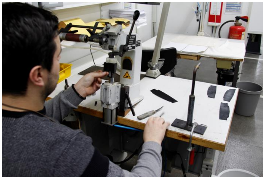
Fig. 13: Dispositivo de sujeción para recubrir los tacones con cuero. Fuente: Gabo
