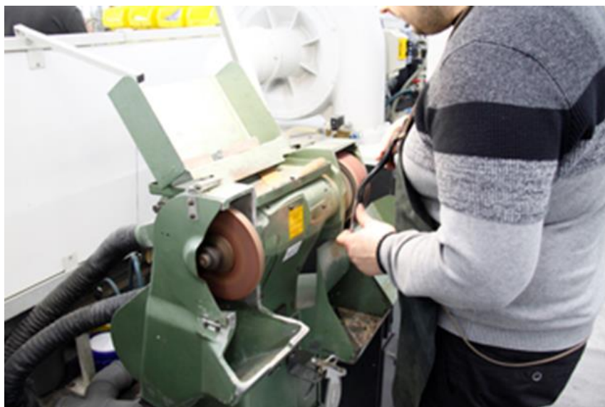
Fig. 16: Acabado de la palmilla con la tira. Fuente: Gabor
