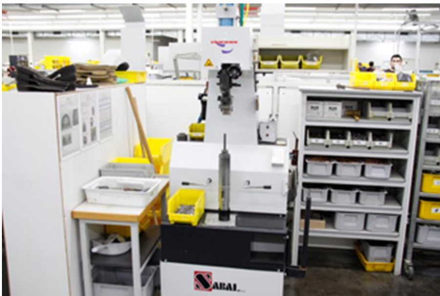
Fig. 20: Máquina para atornillar los tacones. Fuente: Gabor
