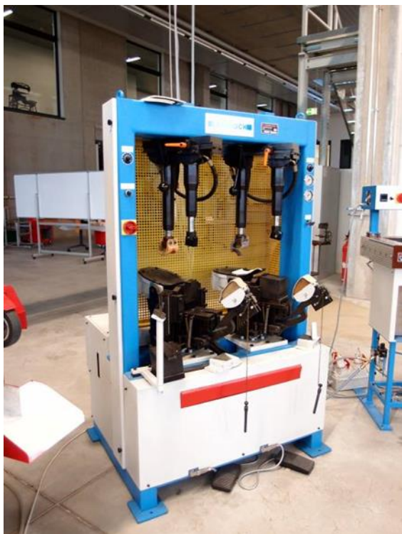
Fig. 18: Prensa hidráulica para suelas. Fuente: ISC
