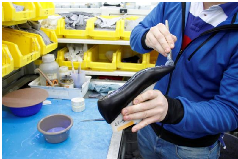
Fig. 9: Aplicación de la imprimación. Fuente: Gabor
