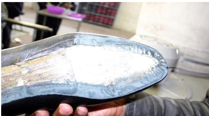
Fig. 6: Ejemplo de un corte cardado en exceso: el entreforro blanco se ve a través del cuero. La resistencia de la unión de la suela ahora depende únicamente de la fuerza estructural del forro y entreforro. Fuente: ISC
