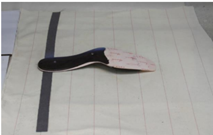
Fig. 15: Palmilla y tira de cuero que va a ser pegada alrededor del canto. Fuente: Gabor
