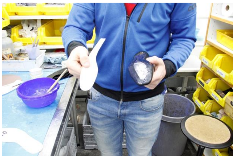
Fig. 10: La función del relleno de planta es nivelar la diferencia en altura entre el borde de montado y la palmilla. Fuente: Gabor
