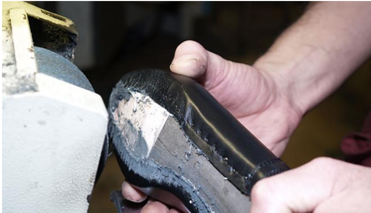
Fig. 3: Cardado manual (lija gruesa). Fuente: ISC
