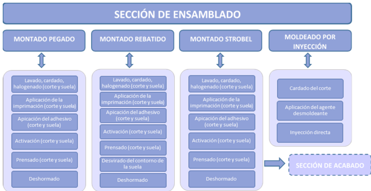
Fig. 2: Los métodos de construcción de calzado más comunes (Fuente: ISC)
