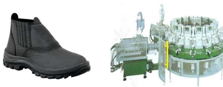
Abbildung 25: Direktanspritzen von Schuhböden
