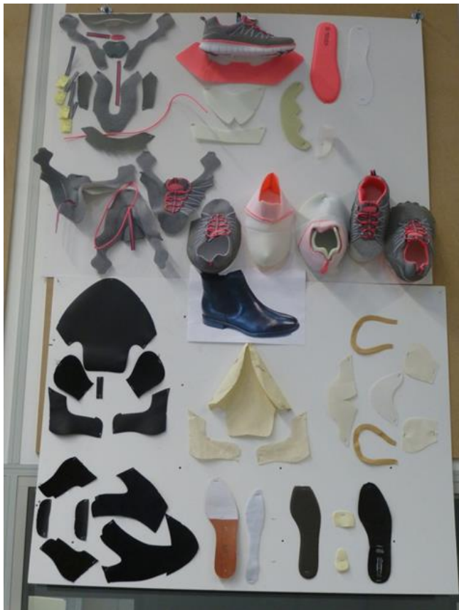
Abbildung 1: Ansichten von Schuhteilen wie auf dem Foto oben können für Auszubildende sehr hilfreich sein, um die Komplexität des Schuhaufbaus zu verstehen
