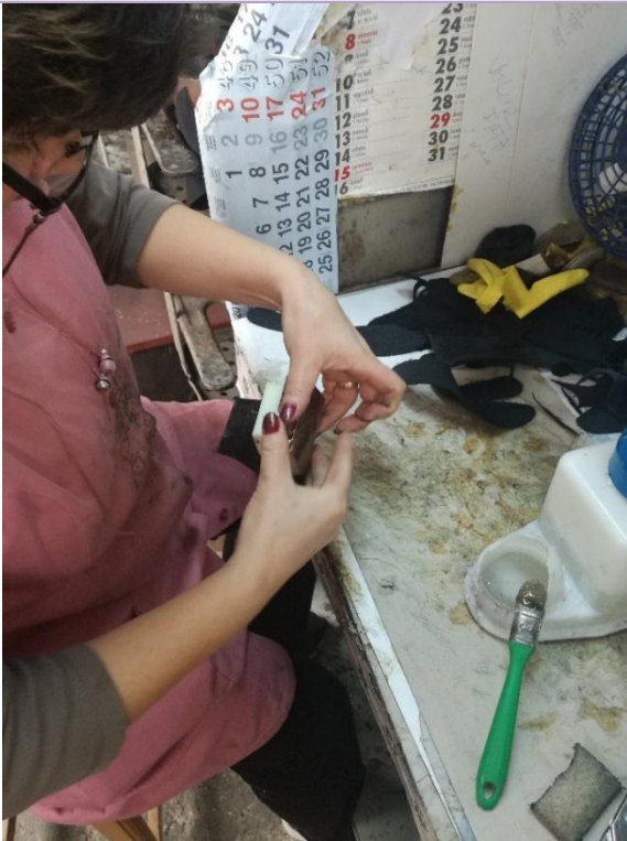
Fig. 24 Scămoșarea rezervei de tragere și a suprafeței tălpii
