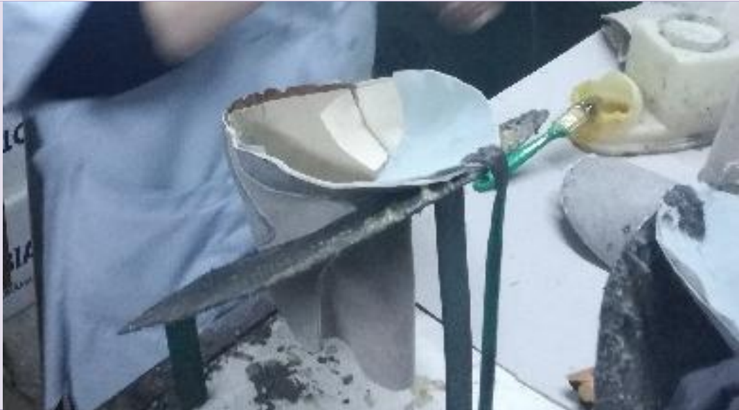
Fig. 16 Aplicarea și termo-lipirea bombeului
