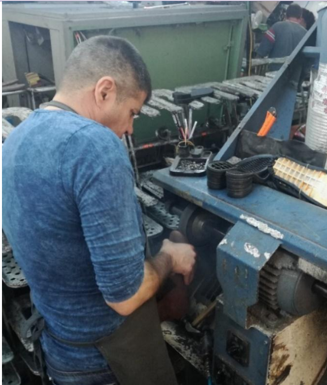
Fig. 24 Scămoșarea rezervei de tragere și a suprafeței tălpii
