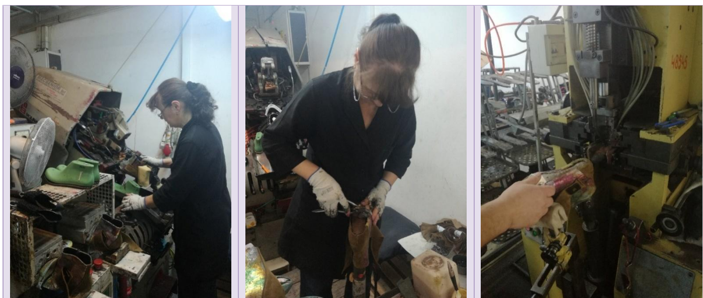
Fig. 23 Tragerea în părți și la călcâi cu ajutorul mașinii de tras
