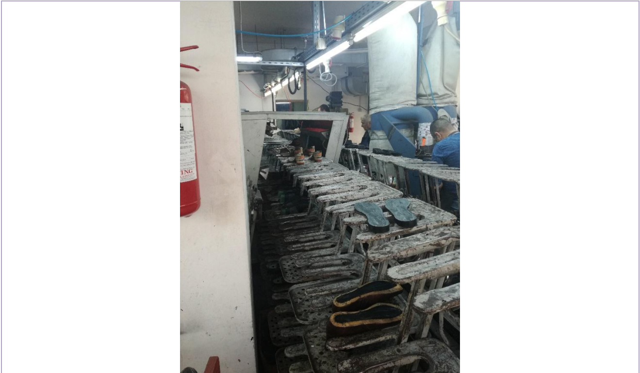
Fig. 27 Reactivarea peliculei de adeziv
