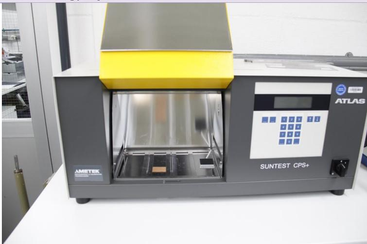
Abb. 65 Lichtechtheitstestgerät
