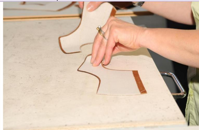
Abb. 47 Zwischenfutter wird aufgebügelt
