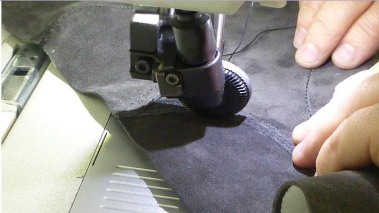
Abb. 16 Steppen mit der Flachbettmaschine
