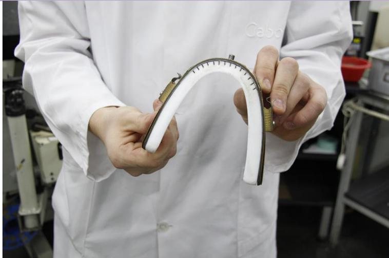
Abb. Spitzenkranz für die Überhol- und Zwickmaschine
