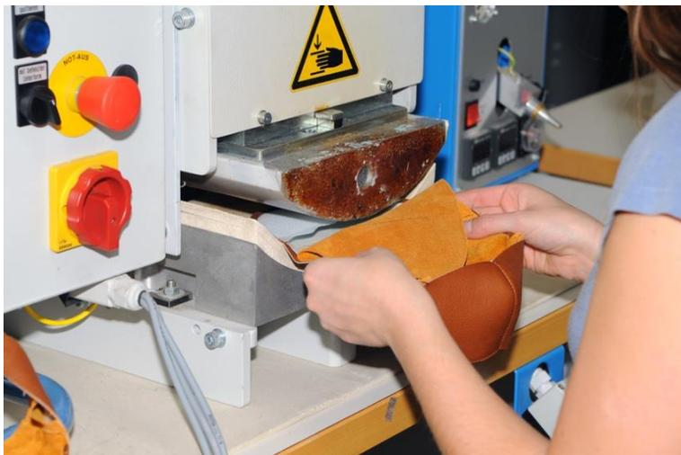
*Abb. 58 Vorderkappe einbügeln*
