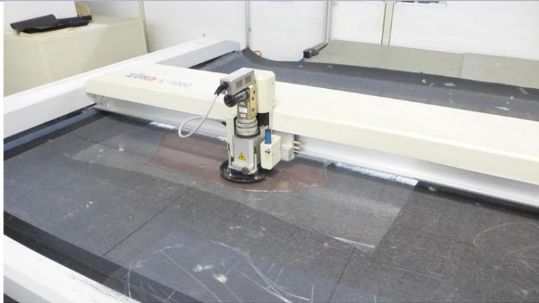
Abb. 5 Zuschnitt der Oberlederteile auf dem Schneidetisch des Computer Optical Systems
