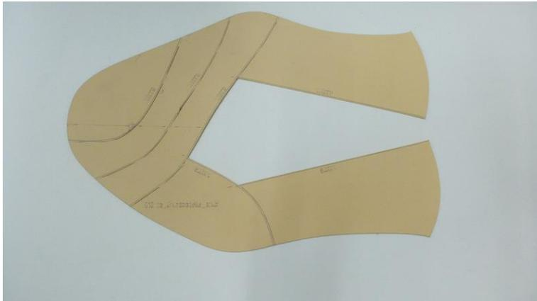
Abb. 71 Eines der Standard-Modelle, anhand derer die Auszubildenden das manuelle Detaillieren lernen
