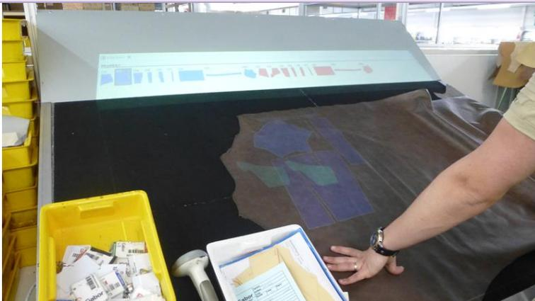
*Abb. 4 Auslage der Oberlederteile am Auslagetisch des Computer Optical Systems*
