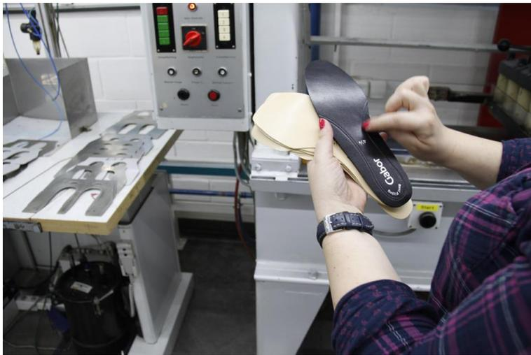
Abb. 36 Vorbereiten der Decksohlen
