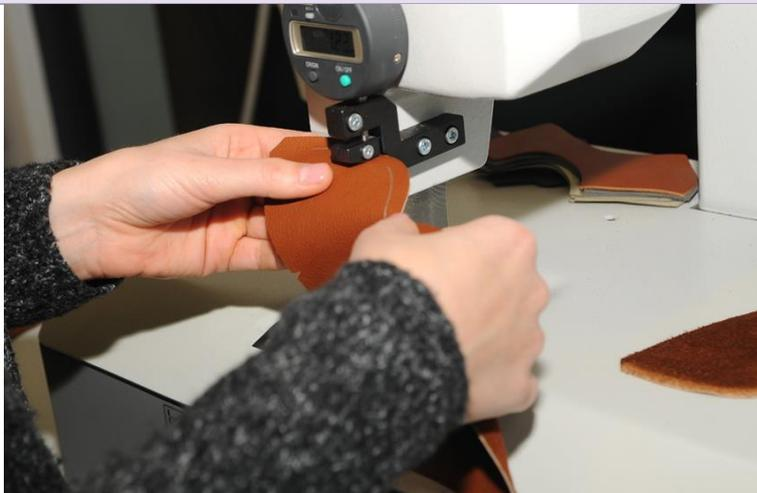
Abb. 43 Dickenmessung der Schärfkante
