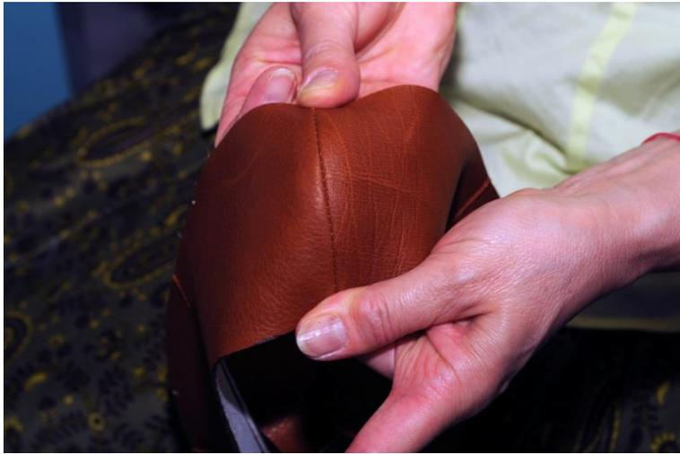
*Abb. 57 Ausgeriebene Bestechnaht (Schaft-Außenseite)*
