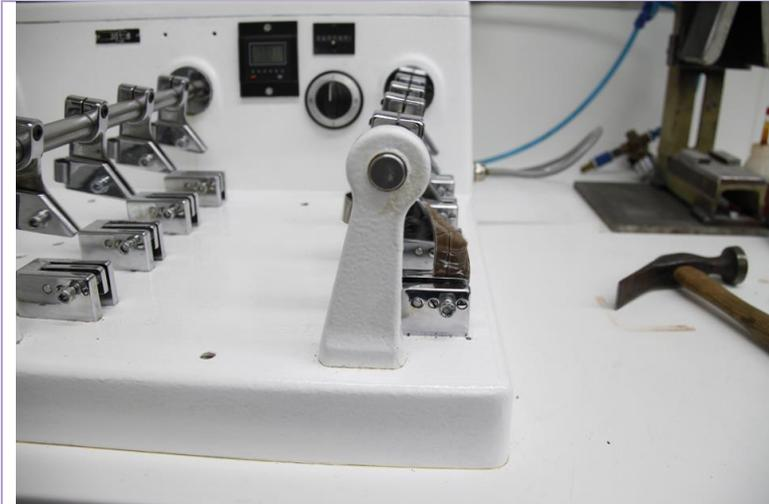
Abb. 66 Flexometer-Test
