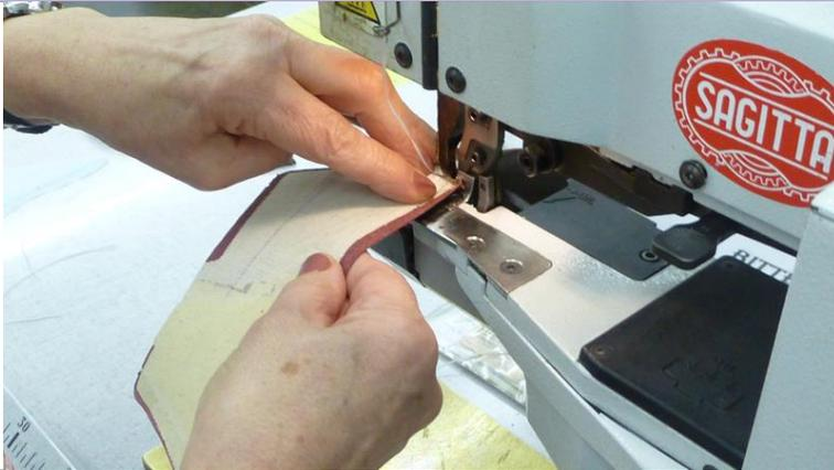
Abb. 18 Buggmaschine
