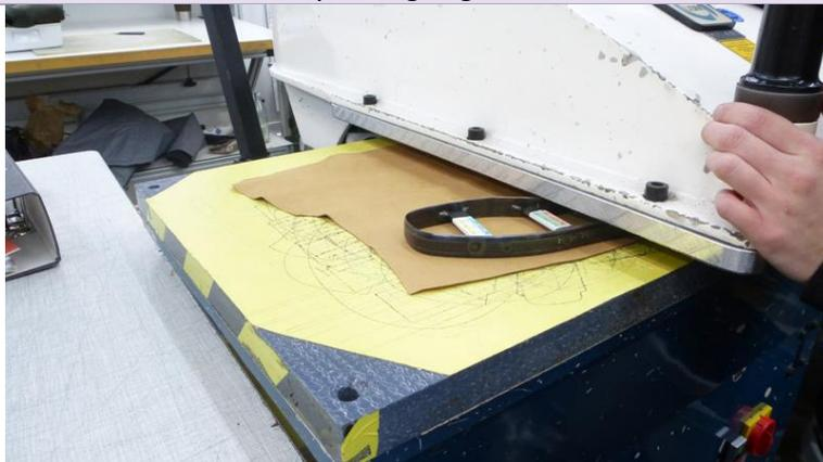
*Abb. 11 Zuschnitt der Decksohlen*
