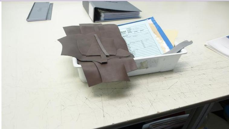
Abb. 6 Partie mit Auftragspapieren und zugeschnittenen Oberschaftteilen
