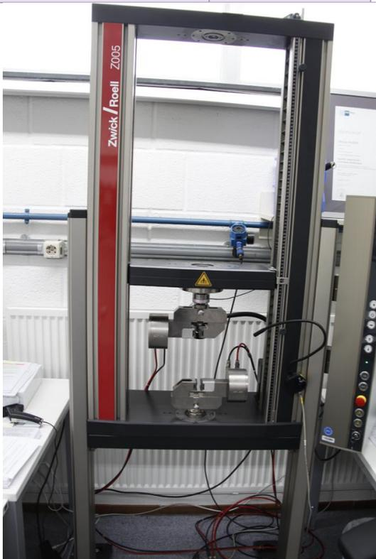
Abb. 64 Zugprüfmaschine
