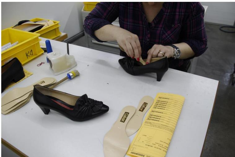
Abb. 37 Einlegen der Decksohlen
